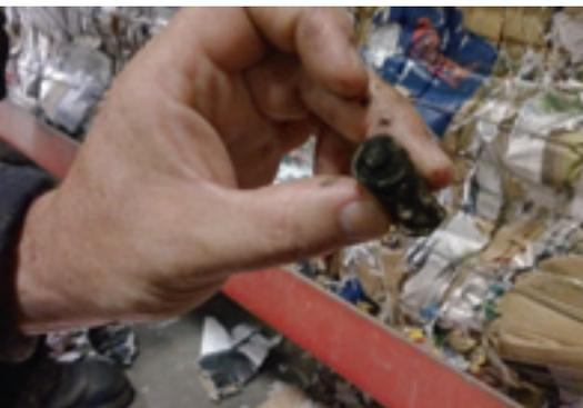
**30.8.** **Brandgeruch in der SLR bei Ballenpresse, leichte Brandspuren bei Ballen, Auslöser vermutlich eine alte Batterie**
